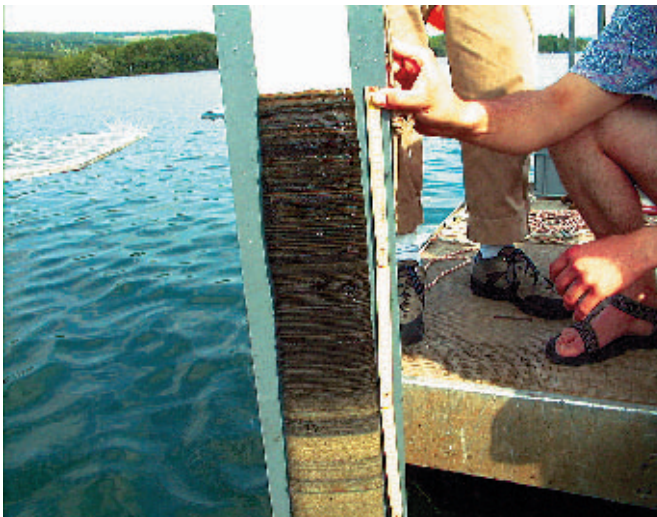
60 Foto einer Schlammsäule, die aus einem Maarsee gezogen wurde. Zur zerstörungsfreien Bergung einer solchen geschichteten Probe wird das Material beim Stechen im Seeboden tiefgefroren.
