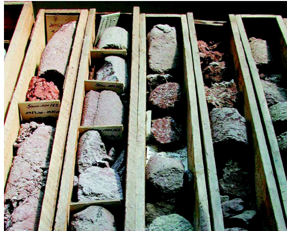
Abbildung 3.32: Kernkisten (Vulkanite) der Bohrung Sam 101/62 . Die Proben in den gezeigten Kisten stellen den noch vorhandenen Kernprobenbestand im Tiefenbereich von 1750 bis 2000 m dar.
