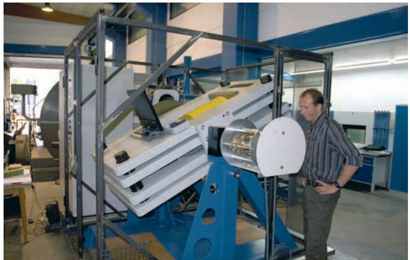
Abb. 2: In der Hochdruckhalle des GeoForschungsZentrums wurde 2005 eine neuartige rotierende Vielstempelpresse installiert. (Foto: Reiner Schulz, GFZ)
