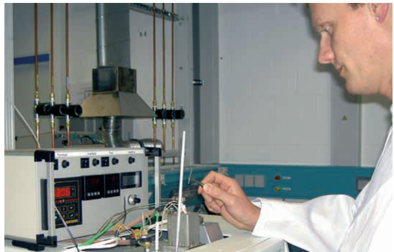
Abb. 3: Die Kohlenwasserstoffbildung wird im Labor durch Aufheizexperimente mit unreifen Muttergesteinen simuliert. Die Ergebnisse werden zur Berechnung von Aktivierungsenergien ( E_a ) und Frequenzfaktoren ( A ) benutzt, die im Prinzip die Stärke der chemischen Bindungen widerspiegeln, die im Verlauf der Kohlenwasserstoffbildung gebrochen werden müssen. Die Anwendung dieser Parameter auf die Aufheizgeschichte von Sedimentbecken ermöglicht die Ermittlung der Erdöl- und Erdgasbildungsrate. Das Foto zeigt die Vorbereitung eines solchen Experiments in unserem Pyrolyselabor (Foto: K. Günter, GFZ).
