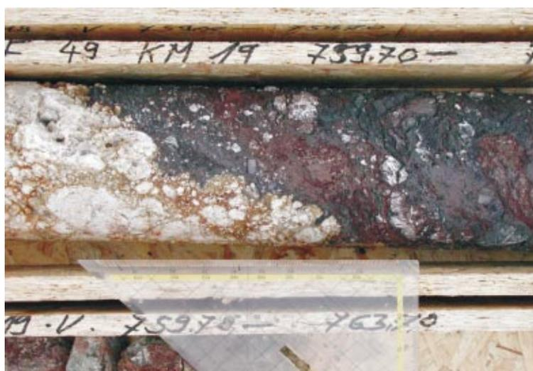
Abb. 11: Bohrkern mit dem störungsbedingtem Übergang von violetten Tiefsetonen zu Karbonaten (Aigion-Fault, Foto: ICDP)
