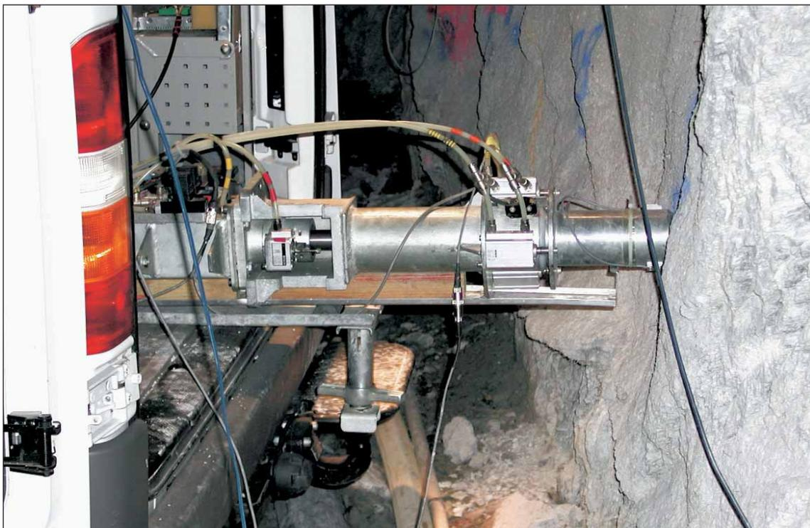
**Abb. 4:** ISIS-Testmessungen im Zugangsstollen Faido des Gotthard-Basistunnels. **a)** Blick auf das GFZ-MobiLab, **b)** der Impact-Hammer im Einsatz an der Tunnelwand. (Fotos: R. Giese, GFZ)
