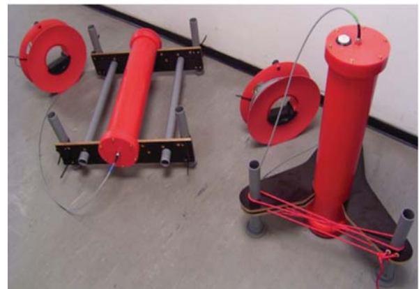
Figure 6: Seewasserfestes Gehäuse für die Magnetfeld-Sensoren.
