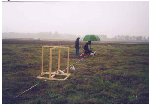
Abbildung 8: Testmessung mit dem 3D-Spulensystem
