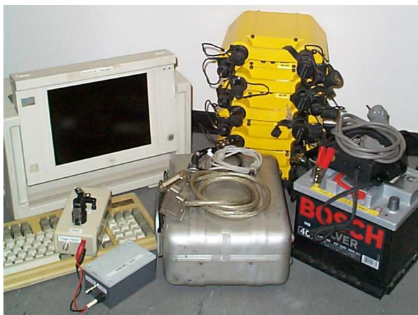
Abbildung 1: Empfänger-Equipment für eine LOTEM-Station mit fünf Komponenten ohne Sensoren (Gewicht 53 kg).
